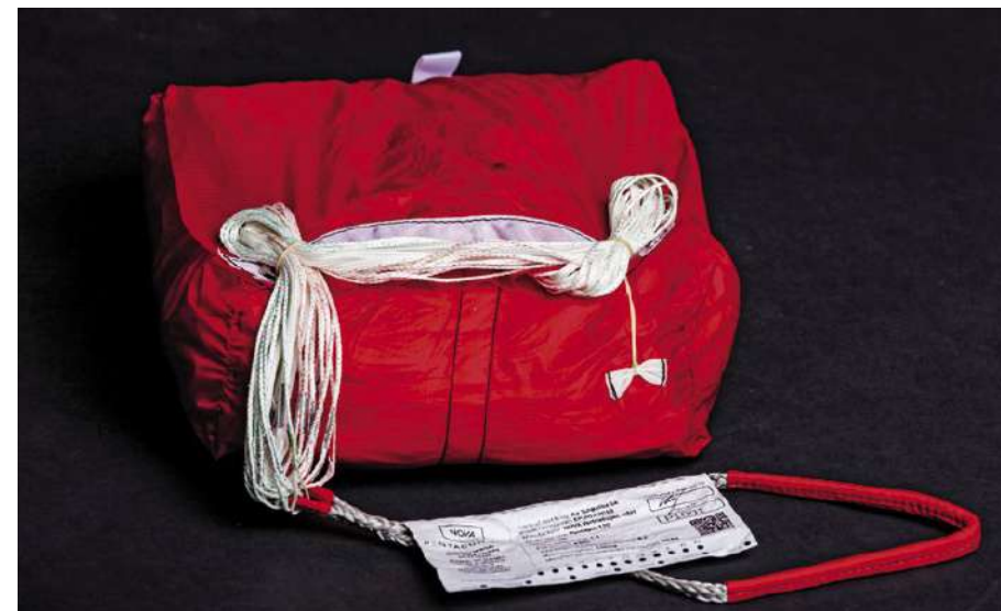
Fermez le POD en sécurisant le quatrième panneau avec les suspentes restantes.
