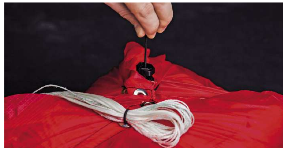
La tension sur l'élastique de fermeture central est contrôlée par le tendeur intégré. Ceci est réglé pour que le parachute soit déployé en tirant le POD par l'élévateur. Le tendeur de boucle est situé sous la quatrième feuille du POD et la tension est réglée avec l'élastique noir
