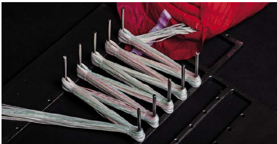
Relâcher l'élévateur. Plier les suspentes en forme de „S“, jusqu'à 90 cm avant l'élévateur.
