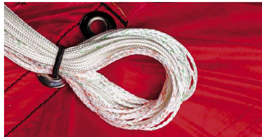
Fermer le POD avec une boucle du suspentage de 5 à 6 cm (approx. 3 doigts).
