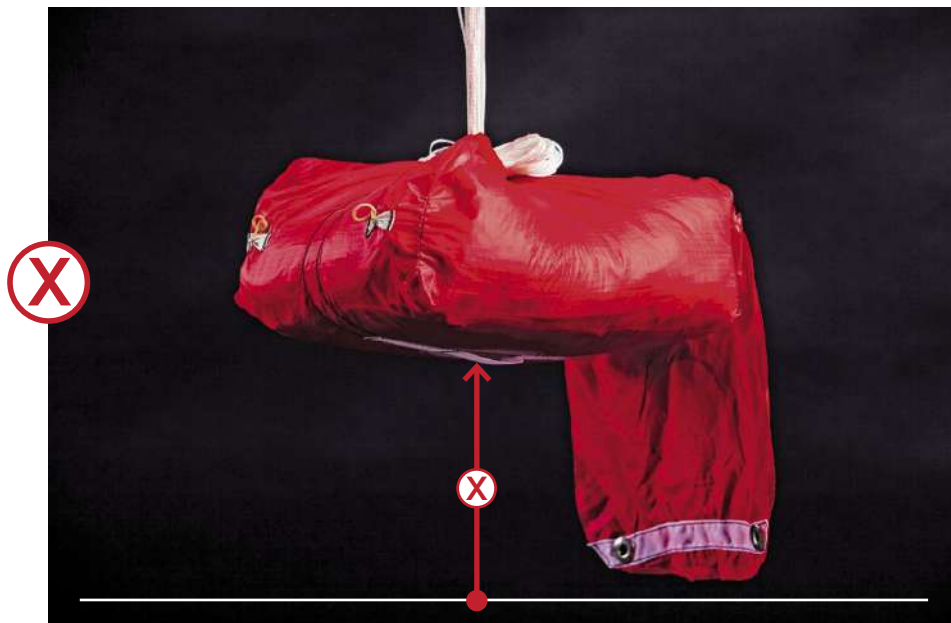
Mauvais: La tension de l'élastique de fixation doit être diminuée à l'aide du tendeur intégré.
