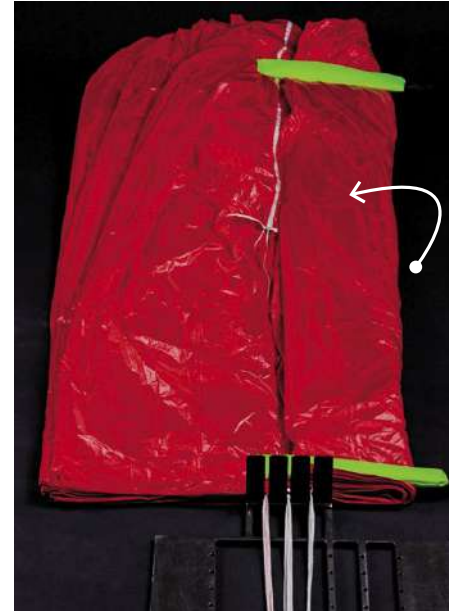
Replier la moitié droite du parachute jusqu'à l'axe central.
